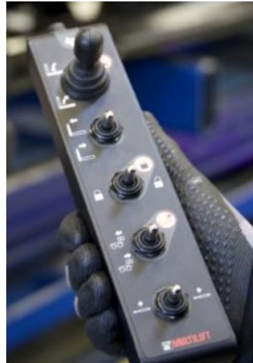
Descenso suave (con velocidad controlada) para reducir el ruido y el desgaste. Esta función desconecta la presión hidráulica y el contenedor llega al chasis con una velocidad suave y controlada.
