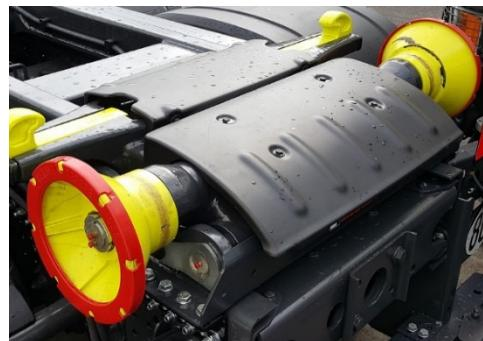
**El concepto atornillado** elimina los tediosos trabajos de soldadura y reduce el tiempo necesario para completar el proceso de montaje. El montaje atornillado también permite aplicar una capa protectora superior de alta calidad en fábrica, lo que ahorra más tiempo valioso.
