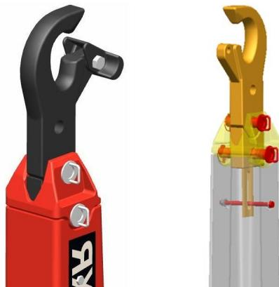
**El bloqueo mecánico del bastidor auxiliar/bastidor trasero (Half Moon)** evita que el bastidor trasero (bastidor basculante) se levante, es decir, al empujar una carrocería sobre un remolque con lanza. Las 'medias lunas' ubicadas en el bastidor auxiliar son la contrapartida de los ejes del bastidor intermedio especialmente diseñados. Al descargar, estos giran y se bloquean automáticamente contra las 'Medias Lunas'.
