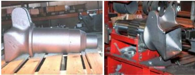
Les parties de structures sont fabriquées à l'aide de la technique de soudage dite : Back Plate (Plaque de renfort derrière les éléments à souder) de manière à garantir robustesse et longévité.
