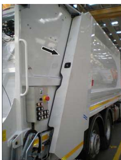
Figura 2 - Taipal externo de fácil abertura com fechadura
