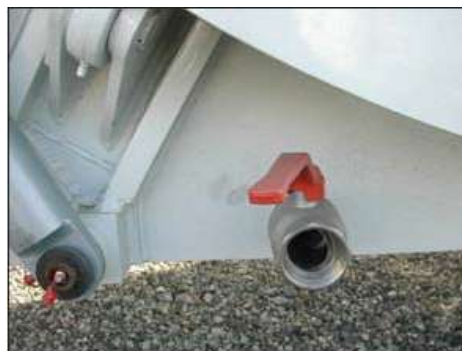
Figura 4 - Válvula para drenagem de líquidos da cuba
